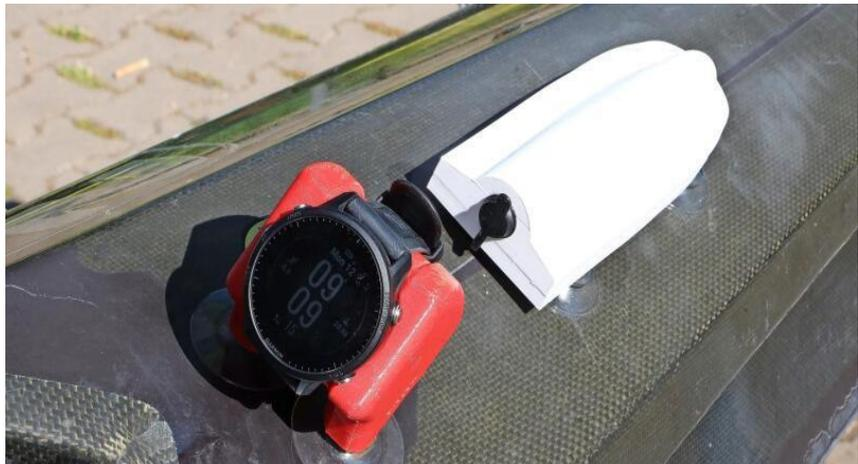
Der Sensor wird einfach mit Saugnäpfen auf das Boot geklebt. Zusätzlich hat Max Staats eine Halterung für seine Sportuhr gedruckt, um nicht auf sein Handgelenk schauen zu müssen.
